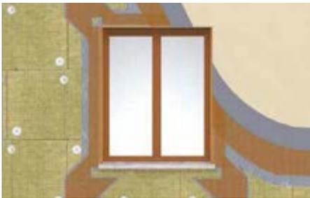
In entrambi i casi il sistema a cappotto deve essere completato mediante l'utilizzo di apposite guarnizioni autoespandenti poste in corrispondenza di serramento e davanzale, profili in rete per la protezione degli spigoli e reti di armatura diagonali da posare sugli angoli delle finestre con inclinazione 45°.
