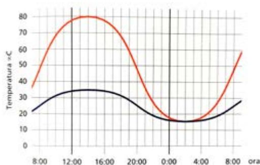
Temperatura sotto la copertura tetto
